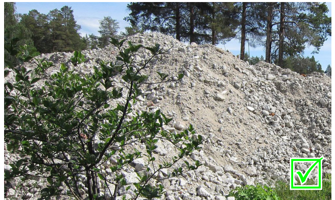
Betong som är bra krossad och sorterad.
