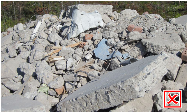
Dåligt krossad och sorterad betong, armeringsjärn, trämaterial.
