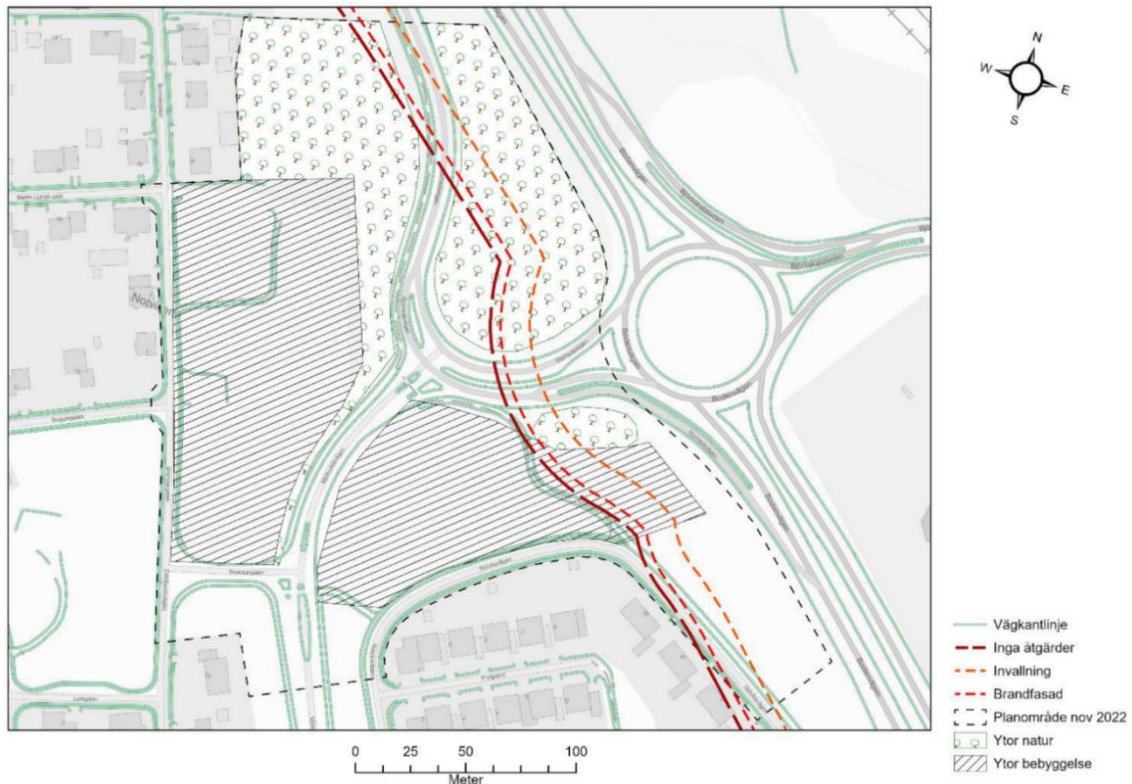
Bild 19. Illustration skyddsavstånd för zon D, ex flerbostadshus, vård, skola samt tillfällig vistelse, exempelvis större hotell/konferens (Riskanalys, Norconsult).
